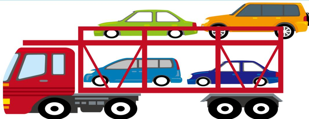
車種:セミ(キャリア) 全長:17.50m(後部荷物のはみ出しなし) 高さ:4.30m 許可証なし
